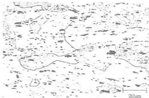
조직 3 > 0.5%HF, 1100-0판재, 냉간 압연하고 Annealing, 재결정되고 등축립자와 FeAl_3 (black)의 불용성 입자(particle), 가공된 조직에 FeAl_3 의 크기와 분포는 annealing에 의하여 영향을 받지 않는다.
