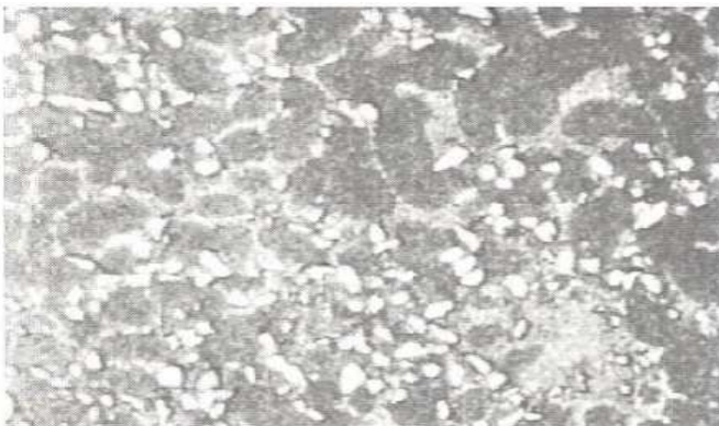
그림 2-29. 주조법에 의해서 제조된 20wt% SiC를 함유한 A359 알루미늄 복합재의 미세조직 사진
